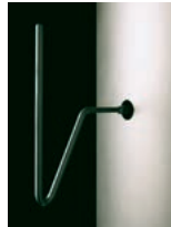
Rüttelmechanismus zur Reinigung des Wärmetauschers
