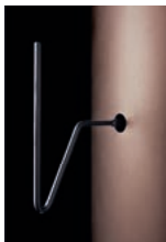
Rüttelmechanismus zur Reinigung des Wärmetauschers
