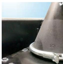
Abgaskuppeldetail bei **RG**-Geräten mit hochschiebbarer Tür
